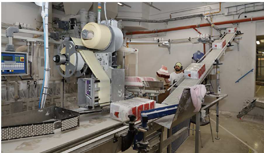
Korn blir til mel. Melet går til pakkemaskiner som setter melpakkene på geledd på samle-båndet. Årvåkne øyne følger med.
